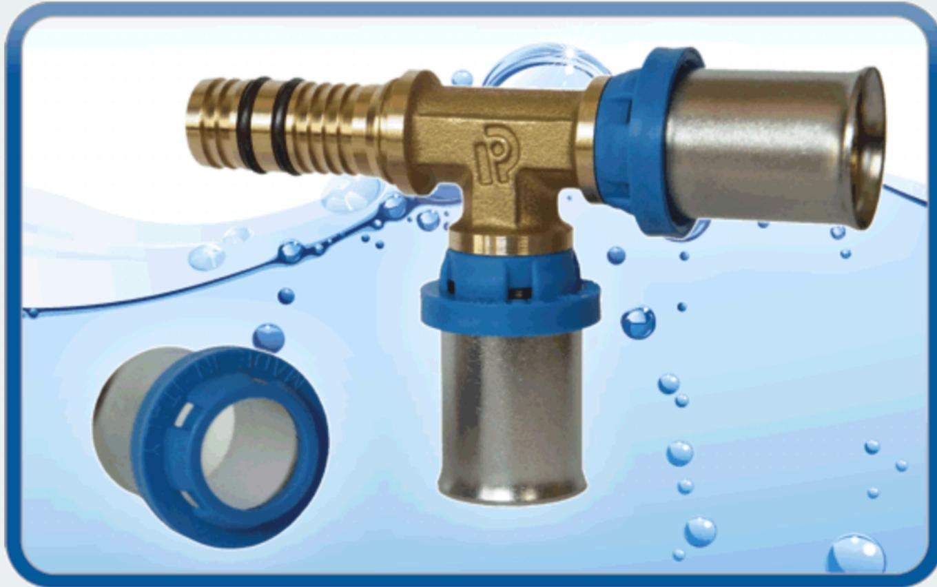
I raccordi a pressione multipinza **FIT-PRESS RINALDI & PETTINAROLI®** in abbinamento ai Tubi Multistrato della serie 7270 garantiscono la perfetta tenuta negli impianti idraulici. Consentono inoltre l'utilizzo di pinze a pressione con profili **TH-H-B-F-U**. I raccordi a pressione **FIT-PRESS** sono realizzati in ottone **UNI EN12165 CW617N** stampato a caldo e lavorato.
